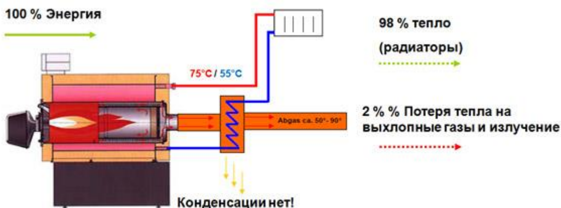
Схема работы котла конденсации, зависящей от температуры возврата
